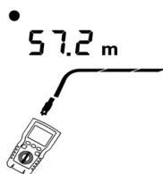
Obrázek 6.15 Rozpojeno na koaxiální kabeláži
