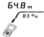
Obrázek 9.2 Stanovení skutečného NVP kabelu
