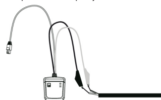
Obrázek 5. Test spojitosti vedení
